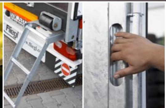
Optimaler Rammschutz und eine Aufstiegsleiter, die der BG-Norm entspricht. Zusammen mit dem eingelassenen Handgriff bietet sie einen sicheren Aufstieg auf die Ladefläche.
