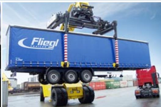
Auf Wunsch wird Ihr Fliegl-Trailer auch bahnverladbar ausgeführt. Selbstverständlich sind die gängigen Bahnkodifizierungen bei Fliegl erhältlich.
