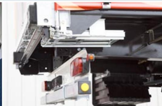
Unterfahrtschutz und Leuchenträger sind als getrennte Bauteile gut geschützt angebracht und somit im Schadensfall einfach und günstig zu ersetzen. Das Heck ist serienmäßig mit zwei stabilen Rammuffern ausgestattet.
