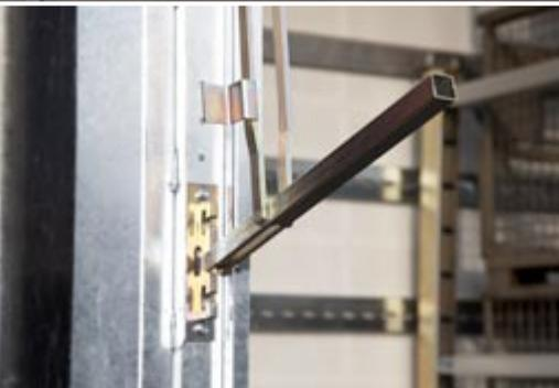
Mechanisches Hubdach: Zwei Hubhöheeneinstellungen sind über den Bedienhebel möglich.
