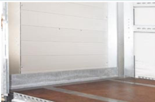
Die massive Front-Rammleiste ist mit dem Chassis verbunden und schützt die Stirnwand vor Beschädigungen durch Gabelzinken (optional, Siebdruckplatten verschraubt).
