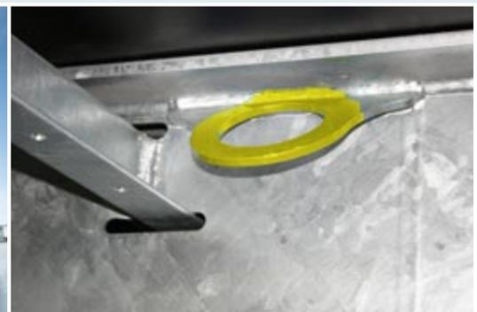
Stabile Fährösen ermöglichen im unbegleiteten Schiffsverkehr die sichere Verzurrung des Trailers.
