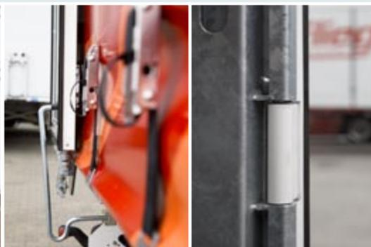
Heckportaltüren mit Doppelgelenkscharnier in die Eckrunge eingelassen – für optimalen Schutz der Türen bei Rampenbeladung. Die Türen liegen im geöffneten Zustand eng an der Seitenplane an. So haben Sie einen optimalen Rückblick bei Rampenfahrten und einen geringeren Luftwiderstand bei Fahrt mit geöffneten Türen.
