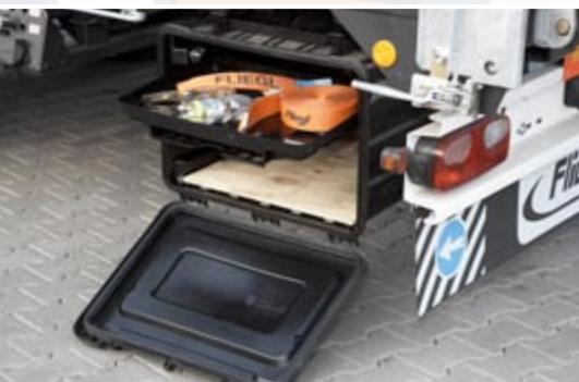
Großer, stabiler Werkzeugkasten mit Schublade und Trennboden.
