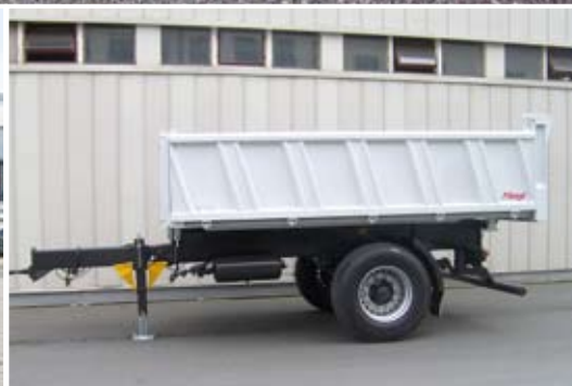
3-Seiten-Kipper mit Einzelachse, 9,5 t ZGG.
