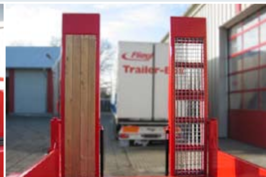
Rampe wahlweise mit Holz oder Gitterrost belegt sowie die Möglichkeit der Nutzung einer dritten Rampe.
