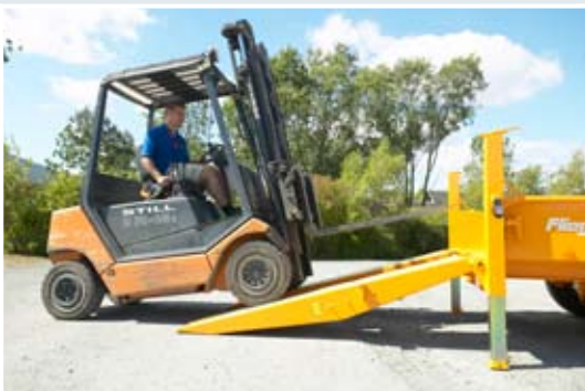
Teleskopierbare verzinkte Heckabstützung.
