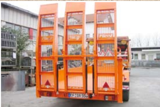
Auffahrrampe als Gitterrostausführung zum Beispiel für Maschinen mit drei Rädern.
