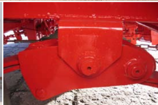
Wartungsarmes Tandemwippen-Aggregat mit Verschleißbuchsen.
