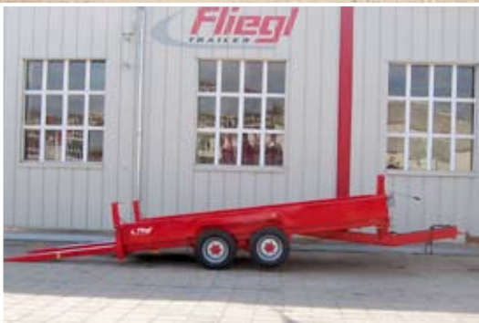
Ladefläche ankipprbar für Maschinen und Geräte mit geringer Bodenfreiheit.
