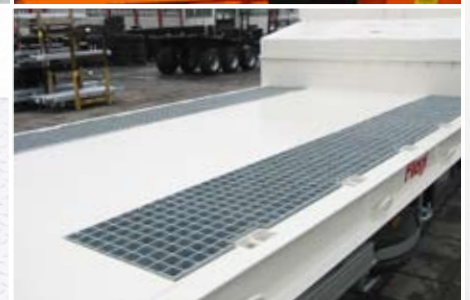
Boden serienmäßig mit 70 mm starken, druck-impregnierten Holzbohlen belegt, optional auch Gitterrostbelag oder aufgeschweißtes Streckgitter erhältlich.
