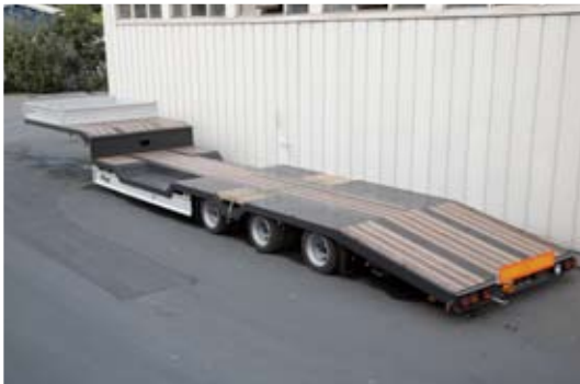
Verstärkter Jumbo-Satteltieflader für den LKW und Landmaschinentransport.
