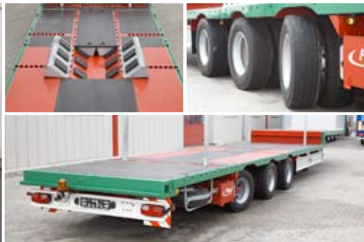
Jumbo Coillaufleger in verstärkter Ausführung mit Rungen-taschen und Lenkachse.
